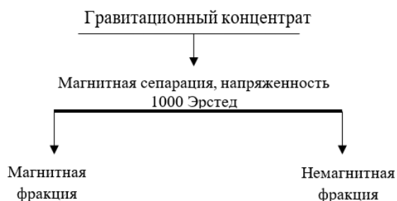
Рисунок 12 – Схема магнитного обогащения в трубчатом анализаторе
